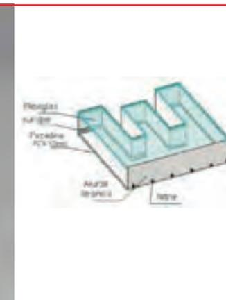
Aluminijumske trake služe za izradu 3D slova i ostalih 3D objekata. Traka je oblikovana na način da obezbeđuje savršeno prijanjanje kako frontalne ploče, tako i ploče koja se koristi za leđa. Širine 100 i 120 mm obezbeđuju dovoljno prostora za ugradnju LED modula ukoliko se vrši izrada svetlećeg natpisa. Najtraženiji efekat je inoks (silver ogledalo).
