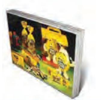
SBox i LBox su sistemi pomoću kojih izrada jednostranih ili dvostranih svetlećih reklama postaje vrlo jednostavna. Tri strane svetleće kutije čine bazni profili, a četvrtu profil sa klapnom. Ugradnja profila sa klapnom omogućava laku i brzu promenu grafike, servisiranje kutije i zamenu fluo cevi. SBox profili su ravni, 100mm širine, a širina elegantnog radijusnog LBox profila iznosi 140mm (spoljne dimenzije).
