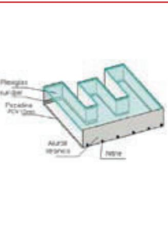
Aluminijumske trake služe za izradu 3D slova i ostalih 3D objekata. Traka je oblikovana na način da obezbeđuje savršeno prianjanje kako frontalne ploče, tako i ploče koja se koristi za leđa. Širine 100 i 120 mm obezbeđuju dovoljno prostora za ugradnju LED modula ukoliko se vrši izrada svetlećeg natpisa. Najtraženiji efekat je inoks (silver ogledalo).
